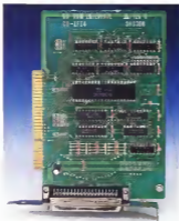
Il controller logic da interfaccia fisica tra il File System ed il disco
